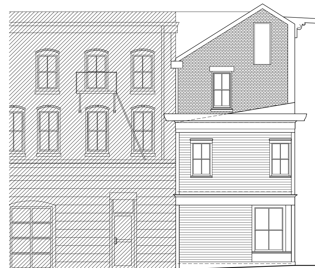
EXISTING ELEVATION - NORTH SCALE: 1/8" = 1'-0"
